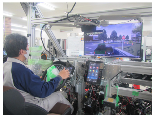
図 3. 実車のデジタルツイン環境を目指した「IVX-D」の運転席周りの様子
