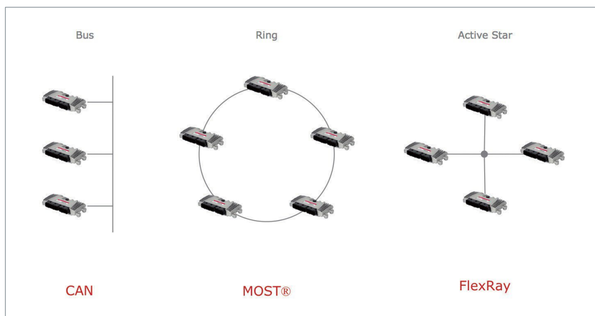
図 7 車載ネットワークプロトコルの代表的なトポロジー
