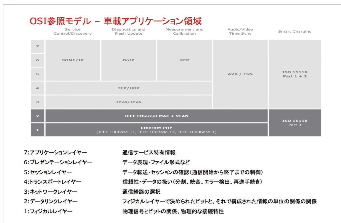
図 5 OSI 参照モデルの各層と車載アプリケーションで使われるプロトコル
