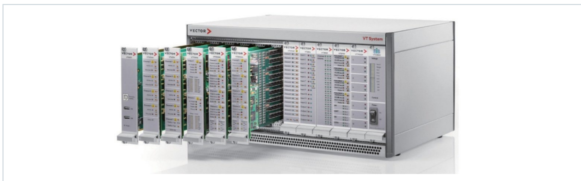
図 16: VT システムはモジュール形式のハードウェア。上記は 12 スロットタイプのケースを使用しているが、6 スロットタイプもある
