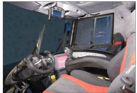
! Bild 2. Bedien- und Anzeigeelemente im Pistenbully-Cockpit.
