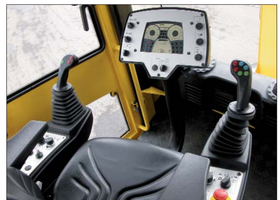
Bild 3. Blick in das Cockpit: Die Bedien- und Anzeigeelemente sind über CAN mit der Steuerelektronik verbunden. Durch eine konsequente Vernetzung hält sich der Verkabelungsaufwand in Grenzen. (Bild: Bomag GmbH)
