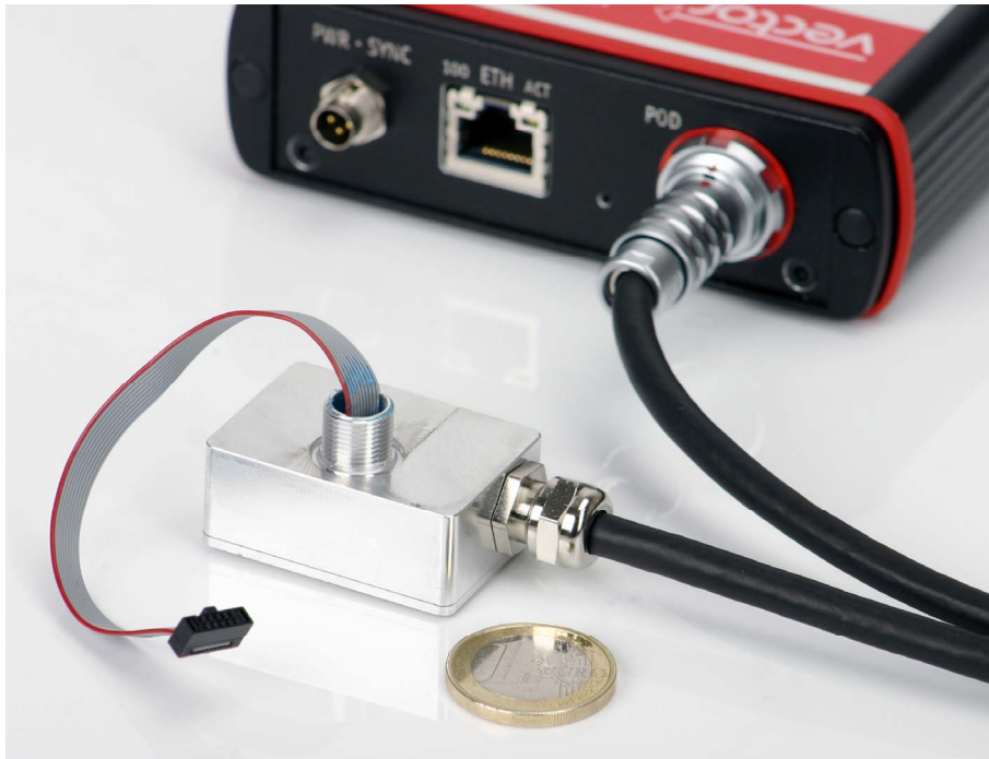
[Bild 2: Mit dem kleinen und robusten POD erfolgt der flexible Anschluss an das Steuergerät.]
