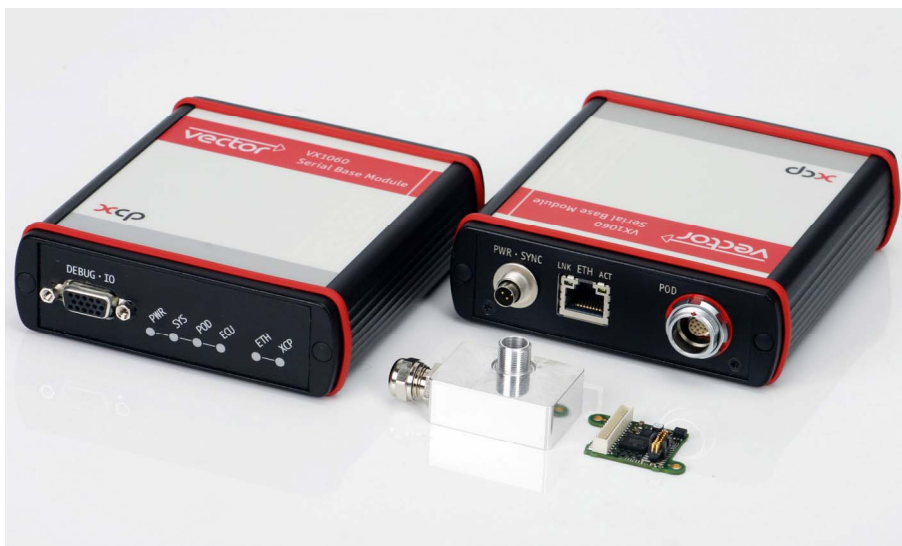
[Bild 1: Schneller Zugriff auf den Steuergeräte-RAM mit der Mess- und Kalibrierhardware VX1060.]
