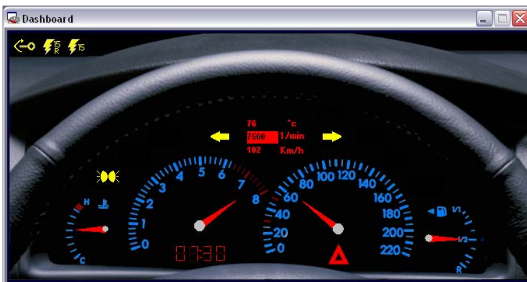
CANalyzer Anzeige-Panel zur Darstellung unterschiedlicher Bussignale
